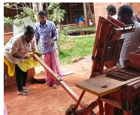
Das Lehmerdegemisch wird passgenau in die Presse gefüllt (oben) und dann manuell zu Ziegeln gepresst (unten).
